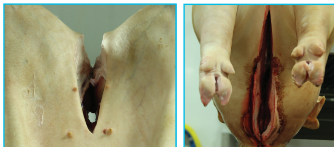
一个全自动工作流程：打开放血刀口，同时 雕肛，之后后腿被劈开，耻骨被打开
